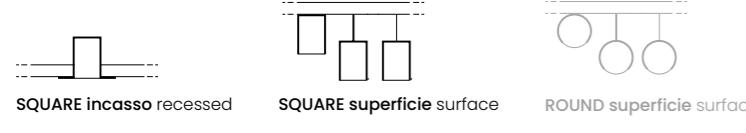
Elemento a sospensione a 48Vdc in alluminio. Diffusore in vetro. Attacco ad incastro magnetico. Compatibile con sistema SQUARE ad incasso (OTBININ-OTBINIB), SQUARE a superficie (OTBINSN-OTBINSB-OTBINSG). Adatto anche al sistema ROUND. Cavetti regolabili. COB Bridgelux. Non dimmerabile. Compatibile con vetri ALFA medio, acquistabili separatamente.
