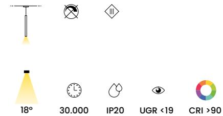
Elemento cilindrico LED a 48Vdc in alluminio. Diffusore in policarbonato. Disponibile ottica (OTLENS) per ottenere angolo di emissione luminosa di 38°. Attacco ad incastro magnetico. Compatibile con sistema SQUARE ad incasso (OTBININ-OTBINIB), SQUARE a superficie (OTBINSN- OTBINSB- OTBINSG). Adatto anche al sistema ROUND. Cavetti regolabili. COB Bridgelux. Non dimmerabile.
